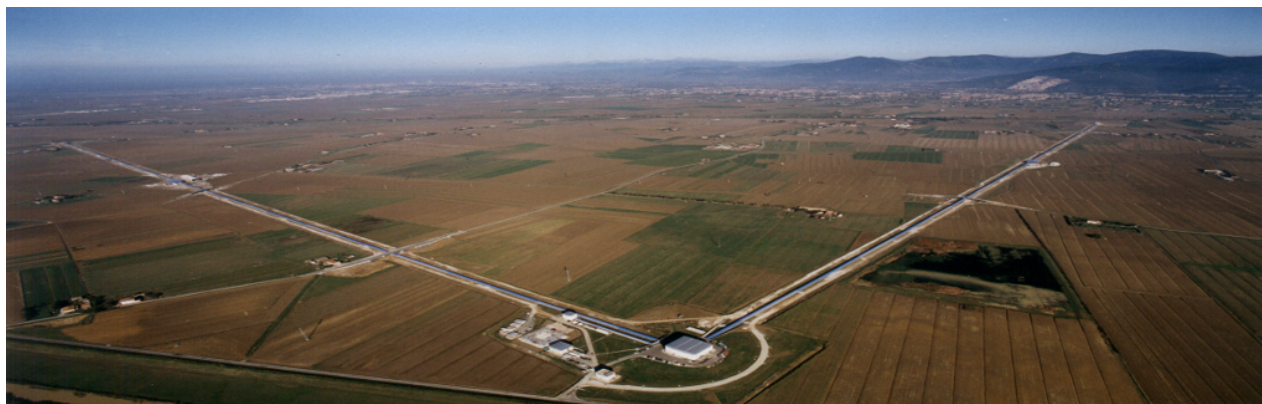
7.8. ábra. A Virgo gravitációs-hullám detektor madártávlatból. A Michelson interferométer egymásra merőleges karjai 3 km hosszúak. A lézervény a karok végéről többször oda-vissza verődve összesen mintegy 120 km-nyi optikai utat tesz meg. A Virgo detektor az EGO, azaz European Gravitational Observatory területén található Pisa mellett. Forrás: http://virgopisa.df.unipi.it/
