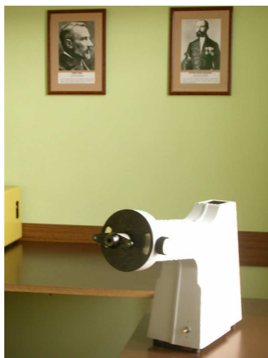
A gyakorlathoz használt polariméter. Balra a műszer, jobbra a belső szerkezete látható
