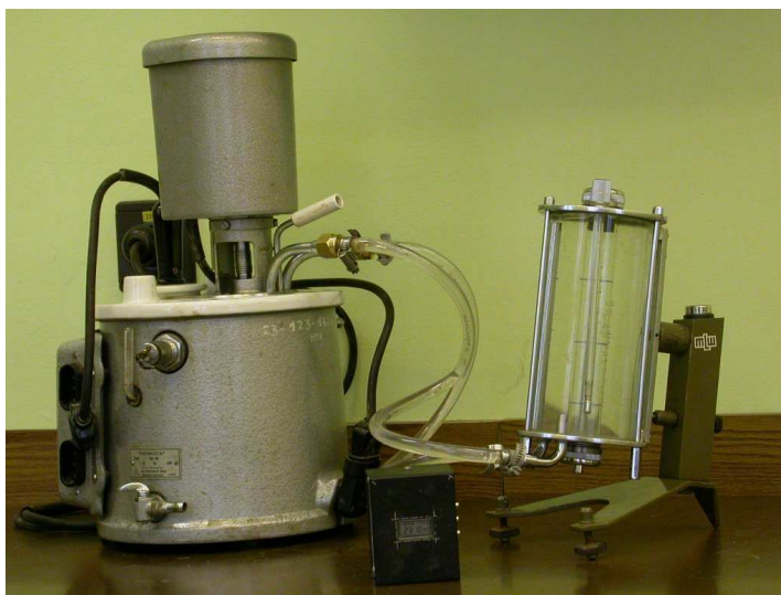
A Höppler-féle viszkoziméter (jobbra) a gyakorlaton használt termosztáthoz csatlakoztatva (balra)
