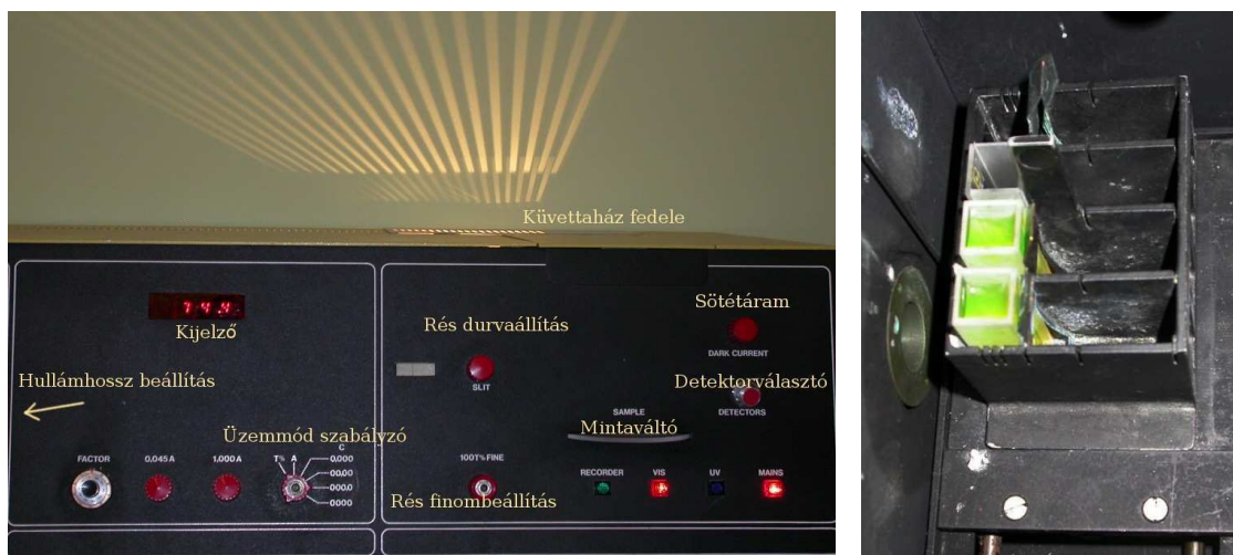
Balra: A spektrofotométer kezelőszervei; jobbra: a küvettház belülről: a fényforrás kilépő rekesze és a küvettatartó a küvettakocsin
