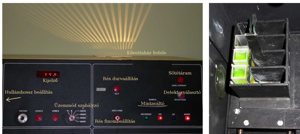
Balra: A spektrofotométer kezelőszervei; jobbra: a küvettaház belülről: a fényforrás kilépő rekesze és a küvettatartó a küvettakocsin
