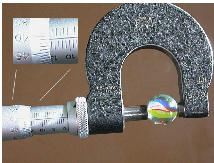
A mikrométercsavar – a gömb átmérője 15,41 mm
