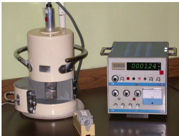
Az ólomtorony és a szcintillációs számláló
