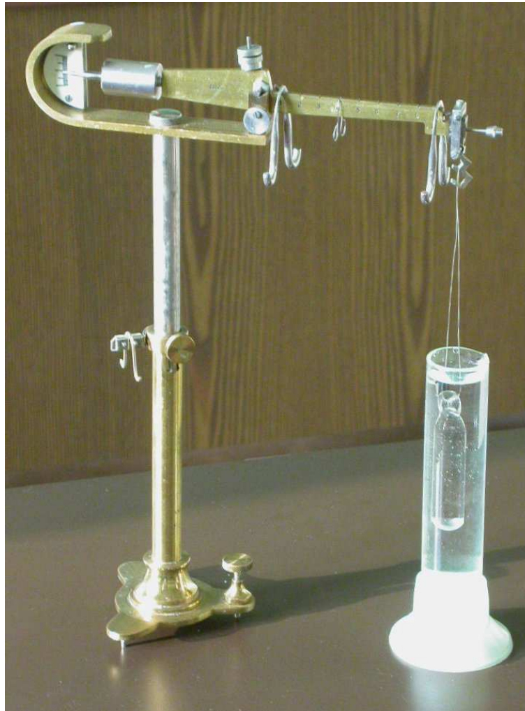
A Mohr–Westphal-mérleg. Egy-egy egységlovas ( 0,1 \text{ g/cm}^3 ) van az 1 és 9 osztásokon, az összesen 10 \times 0,1 = 1,0 , a százados helyiértéket mérő lovas nincs fölrakva (a száron lóg a lovastartón) – eddig 1,00, az ezredes helyiérték pedig a 4-es osztáson van, vagyis a sűrűség 1,004 \text{ g/cm}^3
