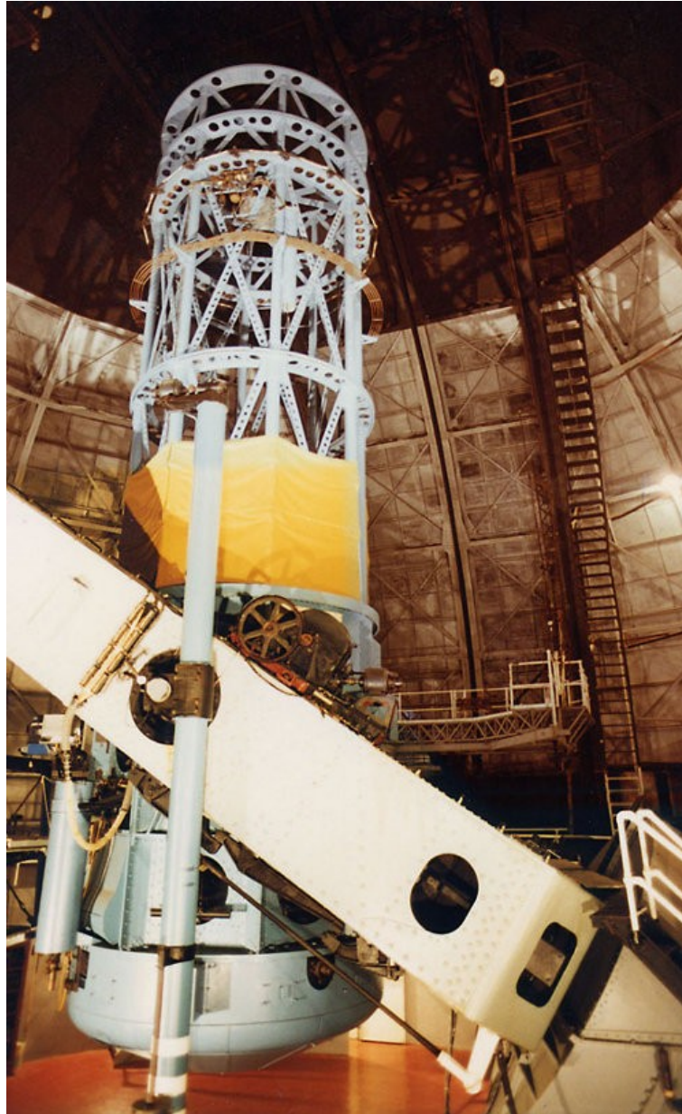
A kaliforniai Wilson-hegyi Observatórium 100 hüvelykes (2,54 m) tükröt tartalmazó Hooker-távcsőve.
