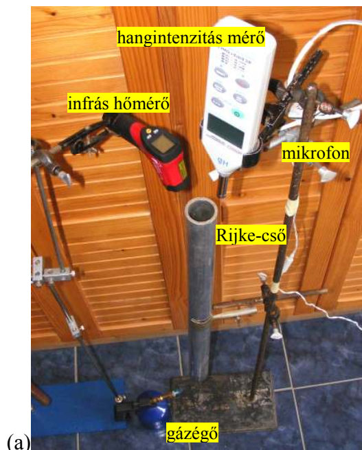
2.ábra: (a) Rijke-cső a mérőműszerekkel együtt; (b) a tanulók méréseket végeznek a projektfeladat során
