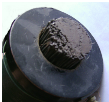
47. ábra: A vasmag felépítése
