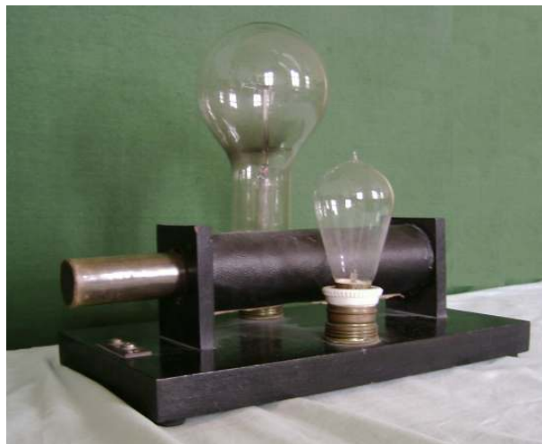
44. ábra: Önindukciós együtttható demonstrálására szolgáló eszköz
