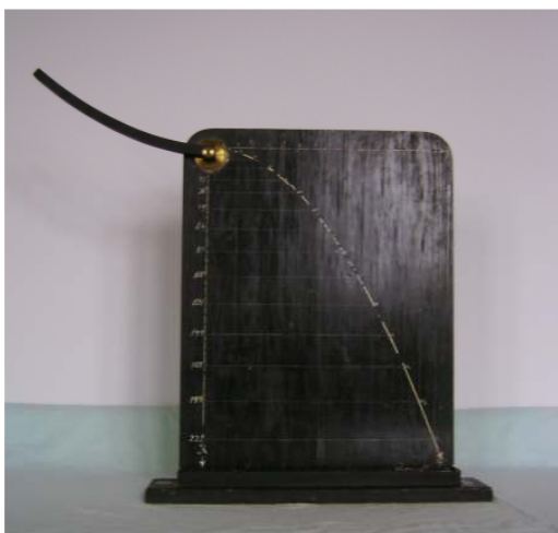
10. ábra: Eszköz vízszin irányában kilökött testek esésének tanulmányozására
