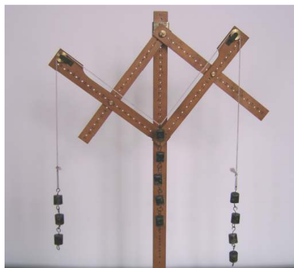
14. ábra: A súlyokkal terhelt fonál éppen a karokkal párhuzamosan helyezkedik el, azaz teljesül a paralelogramma szabály
