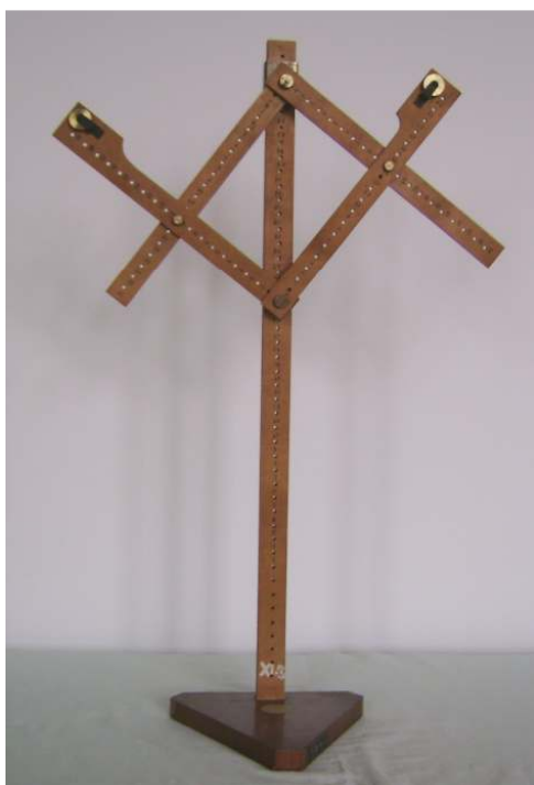
13. ábra: Az eszköz a paralelogramma szabálynak megfelelően rögzített karokkal
