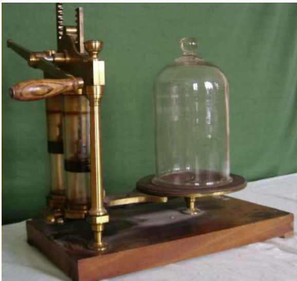
31. ábra: Köpűs légszivattyú (melyet Hód-Mező-Vásárhely városa ajánlott fel a szertárnak 1863-ban)
