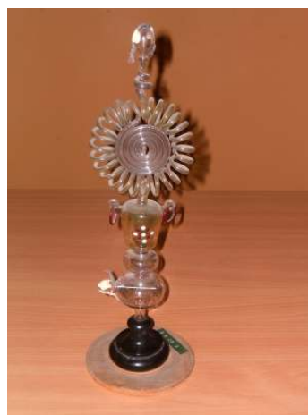
29. ábra: Színezett üvegből készült, spirális alakú Geissler-cső 1900.
