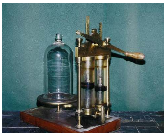
23. ábra: Kétköpűs légszivattyú 1863.
