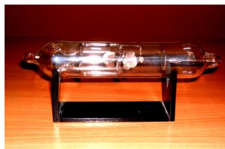
40. ábra: Alumínium kerékkel felszerelt Crookes-cső
