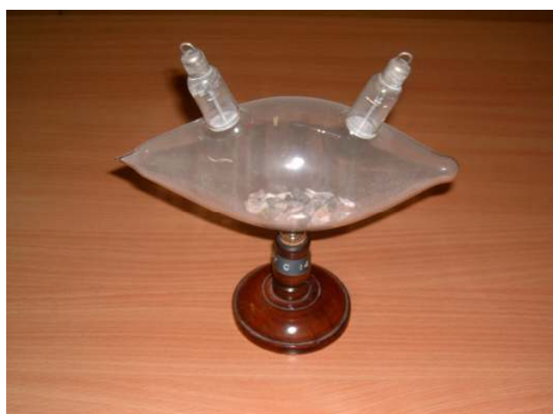
37. ábra: Tojás alakú Crookes-cső, foszforeszkáló pectolith ásványdarabokkal 1900.
