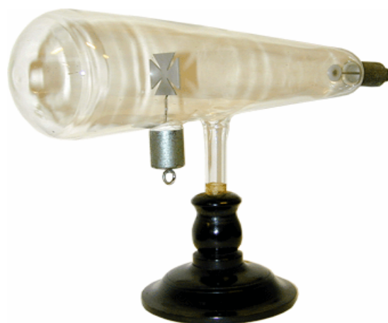
6. ábra: Crookes-féle Máltai kereszt cső
