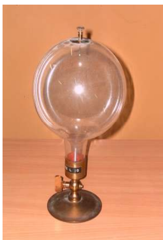
26. ábra: Légszivattyúra helyezhető gömb elektromos kisülések kimutatására 1863.
