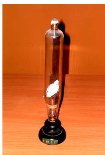
38. ábra: Henger alakú Crookes-cső, foszforeszkáló 1900.
