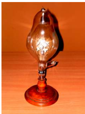
35. ábra: Öblös Crookes-cső lumineszkáló virágcsokorral 1906.
