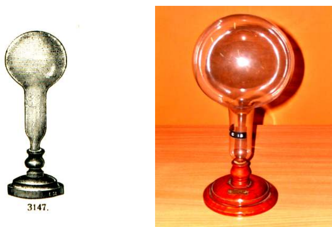
28. ábra: Elektród nélküli Tesla-vákuum-gömb
