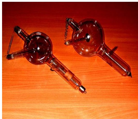
43. ábra: Egyszerű röntgenlámpa platina antikatóddal 1906.
