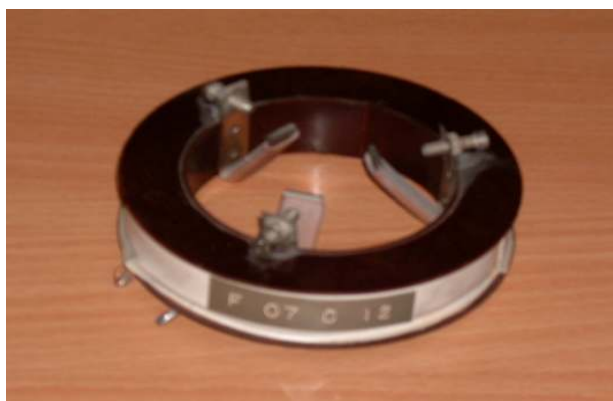
41. ábra: Crookes-csövekhez gyártott ún. eltérítő tekercs 1906.
