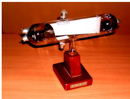
39. ábra: Kétréses Crookes-cső 1906.
