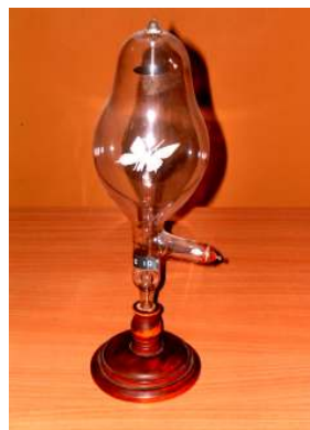
36. ábra: Öblös Crookes-cső lumineszkáló lepkével 1906.
