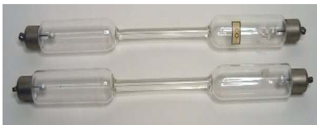
32. ábra: Geissler-Plücker féle spektrálcsővek 1912.
