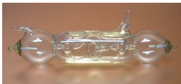
31. ábra: Geissler-cső fluoreszkáló folyadékkal töltve 1899.
