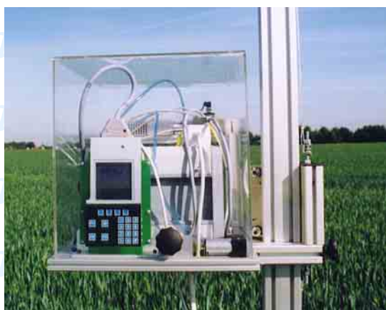
Az elkészített fotoakusztikus ammóniamérő rendszer fényképe
