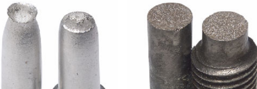
Tipikus mérsékelten képlékeny, ún. cup-and-cone töret
