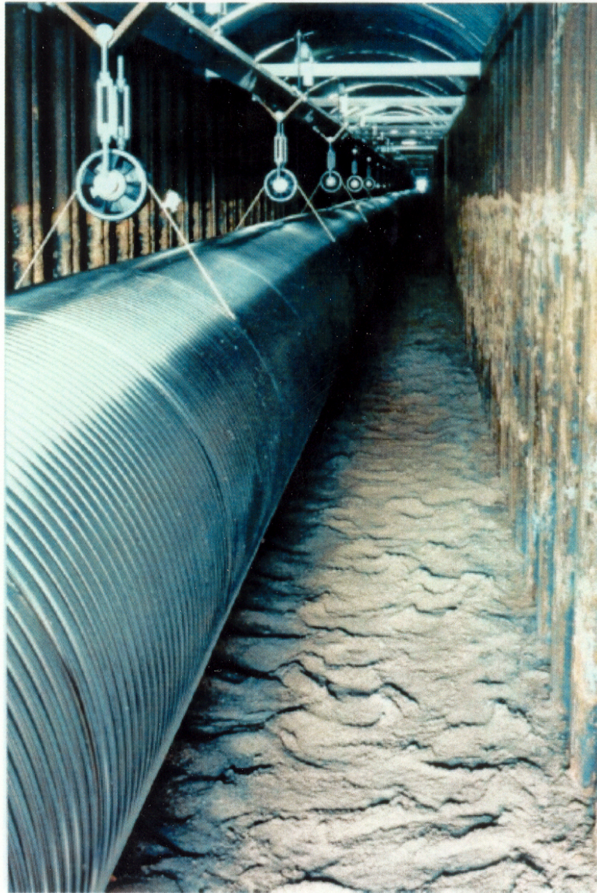
Einer der beiden Meßarme des Gravitationswellendetektors GEO600 bei Hannover (Bild: GEO600/Uni Hannover).
