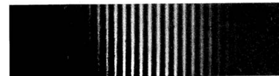
6.1. ábra. Kettős nyílás okozta interferenciacsíkok a 6.3. ábrán látható elrendezés felhasználásával
