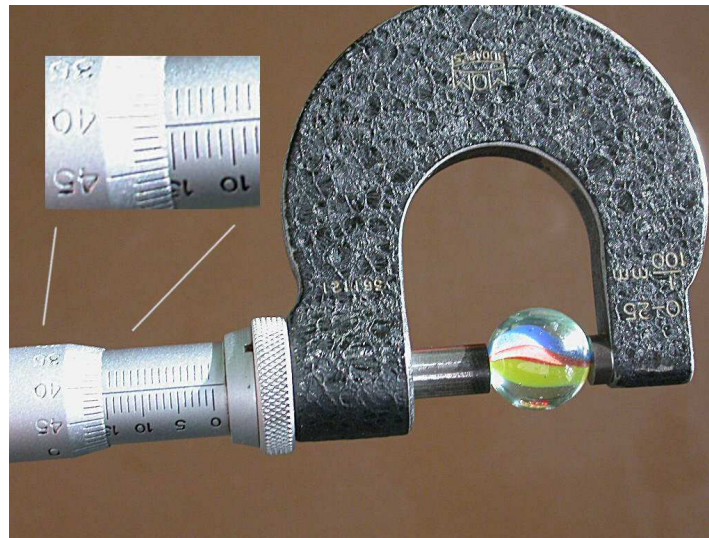
A mikrométercsavar – a gömb átmérője 15,41 mm
