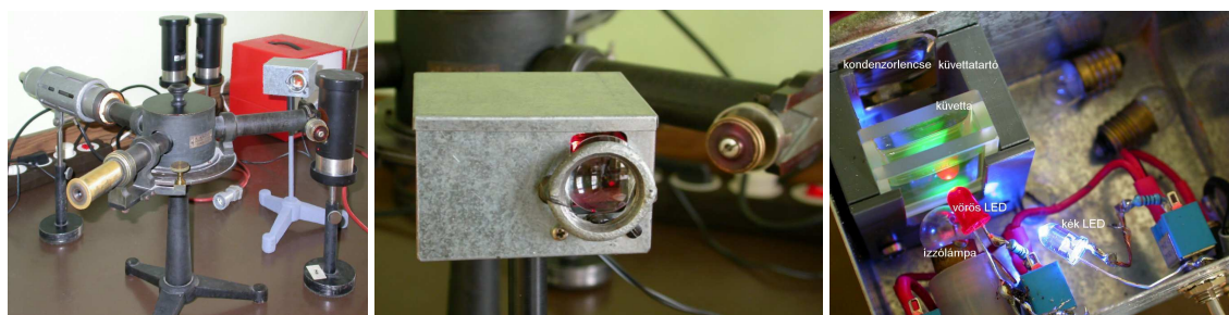
Balra: a gyakorlat eszközei; középen: a fényforrásokat és küvetta tartalmazó kombinált fényforrás a kondenzor felől; jobbra: ennek belső felépítése
