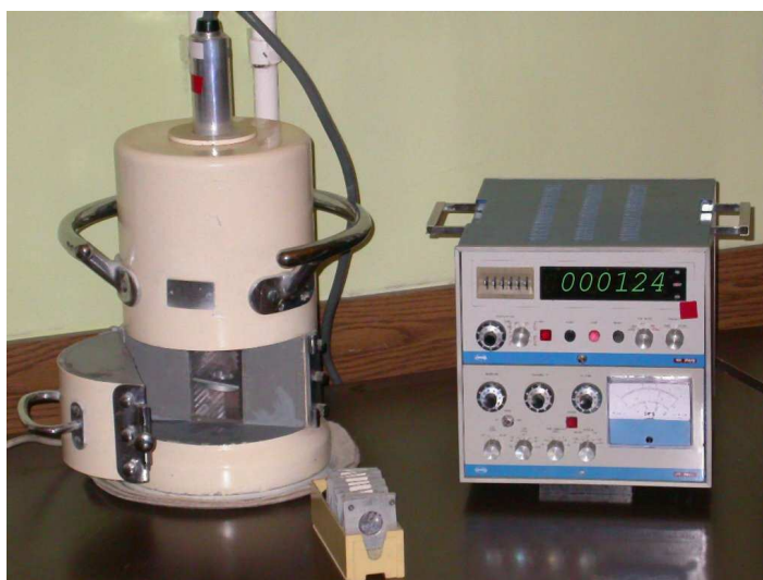
9.1. ábra. Az ólomtorony és a szcintillációs számláló
