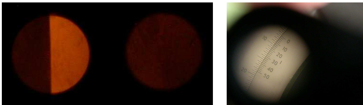
8.2. ábra. Bal panel: a polariméter látómezejének két lehetséges állása: balra a félhold alakú látómezőben átmenő fény mutatja, hogy a műszer átengedi a poláros fény egy részét – jobbra mindkét félkör félárnyékos, helyesen állapítottuk meg a poláros fény síkját. Ilyenkor a forgatás szögét a nóniusz segítségével lehet leolvasni (jobb panel; ebben a beállításban 6,74°).
