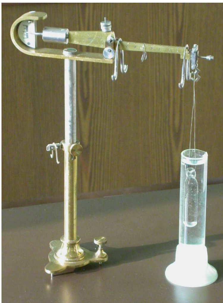
C.1. ábra. A Mohr-Westphal mérleg. Egy-egy egységlovas ( 0.1 \text{ g/cm}^3 van az 1 és 9 osztásokon, az összesen 10 \times 0.1 = 1.0 , a százados helyiértéket mérő lovas nincs fölrakva (a száron lóg a lovastartón), eddig 1.00, az ezredes helyiérték pedig a 4-es osztáson van, vagyis a sűrűség 1.004 \text{ g/cm}^3 .
