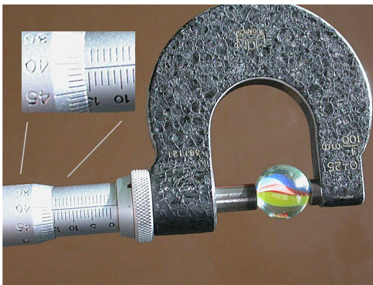
B.3. ábra. A mikrométercsavar – a gömb átmérője 15,41 mm.
