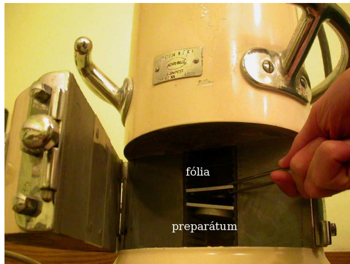
9.2. ábra. Az alumíniumfóliák behelyezése és kivétele csipesszel történik! A preparátumot TILOS elmozdítani a gyakorlat folyamán!
