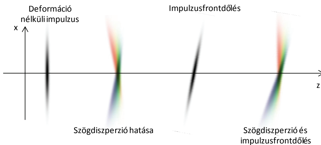
II.6. ábra. A szögdiszperzió és az impulzusfrontdőlés szemléletes hatása egy z irányba terjedő impulzusra. Balról jobbra: deformáció nélküli impulzus térbeli intenzitás eloszlása; a szögdiszperzió hatása bizonyos távolság megtétele után; dőlt impulzusfronttal rendelkező, de z irányba terjedő hullám-csomag; valamint az impulzusfrontdőlés és a szögdiszperzió együttes hatása az intenzitás térbeli eloszlására.
