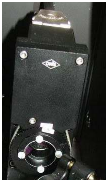
15. ábra Az OWIS DRT 40 forgatómotor a rászertelt félhullám-lemezzel
