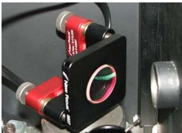
7. ábra New Focus Picomotorral felszerelt tükörtartó az Nd:YAG lézer kimeneténél
