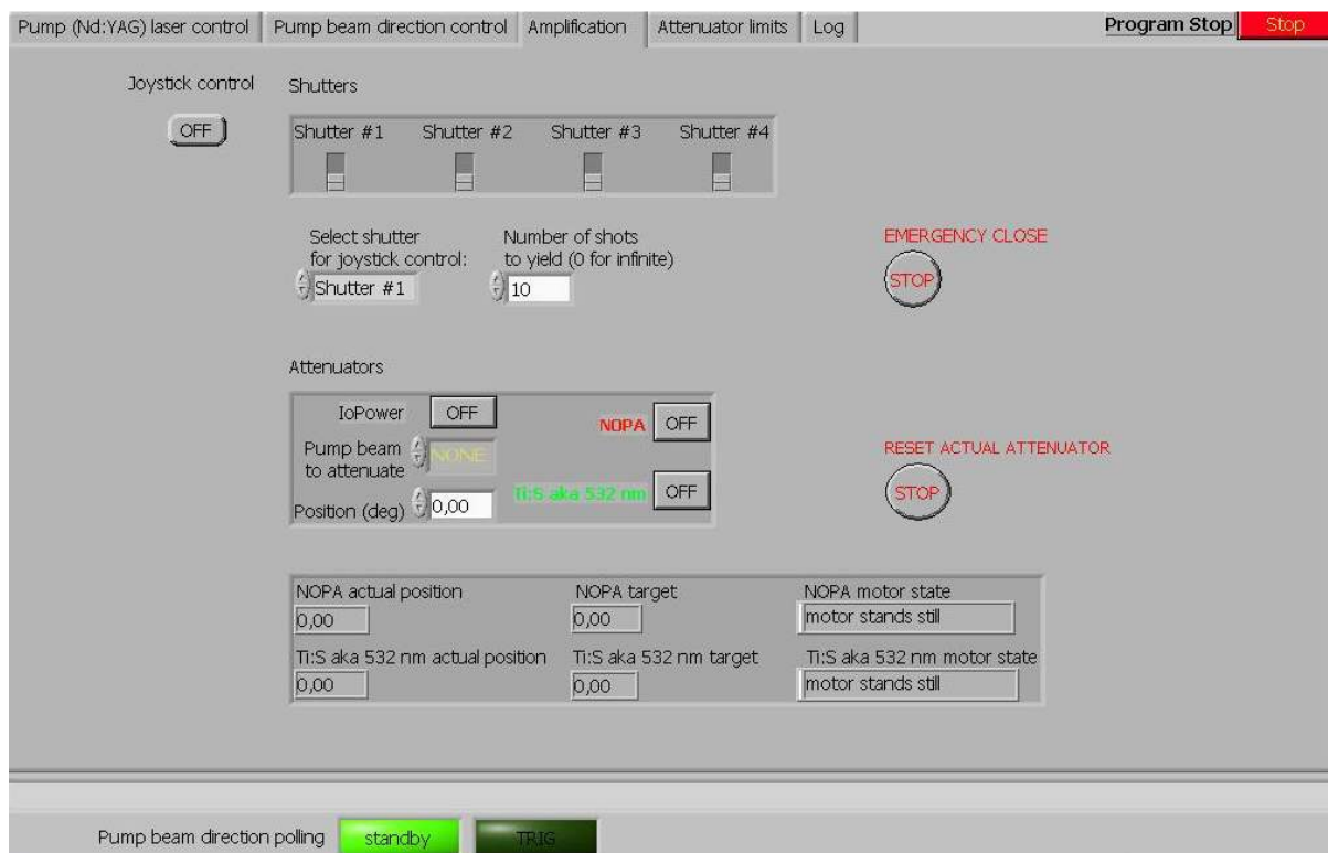
16. ábra A nyalábenergia- és a fénymegszakító-vezérlő programrész közös előlapja
