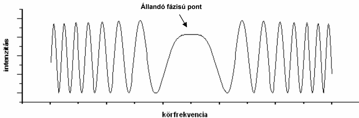
12. ábra Spektrális interferogram frekvenciatengely menti metszete
