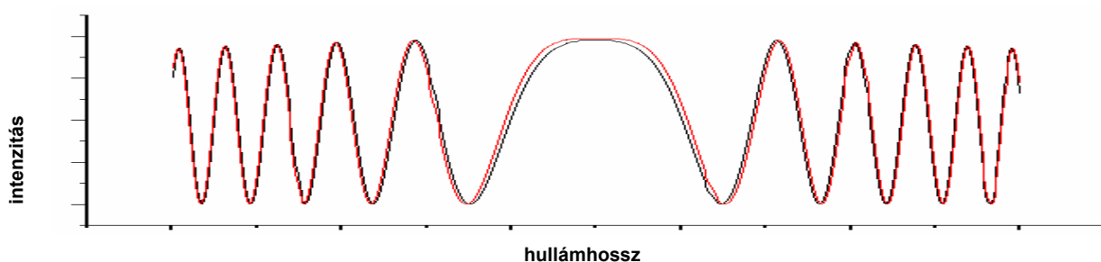
16. ábra Normált spektrális interferogram intenzitás eloszlása Sormetszet (fekete) és illesztett szinuszfüggvény (piros)
