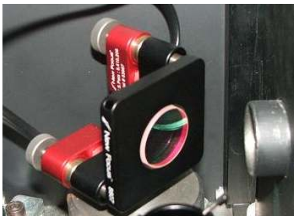
5. ábra New Focus Picomotorral felszerelt tükörtartó az Nd:YAG lézer kimeneténél
