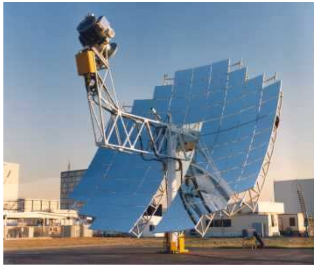
20. ábra: Parabola tányéros Stirling-motorral felszerelt naptükröt (forrás: Wikipedia)
