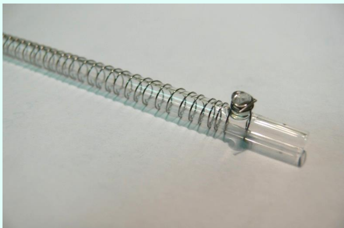
Boro-szilikát üveg, fűthető csőszakasz 300-400°C (termodeszorpcióhoz)
