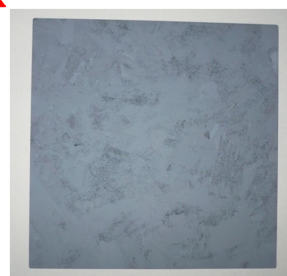
A texturált szelet elektronmikroszkópos képe és fényképe.
